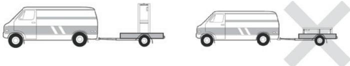
De uitrusting moet altijd verticaal op een pallet en in de oorspronkelijke verpakking opgeslagen en getransporteerd worden. Als de uitrusting horizontaal wordt opgeslagen of getransporteerd, moet met het inschakelen ten minste 24 uur worden gewacht.
