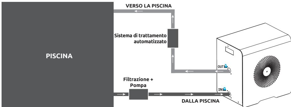
Il filtro a monte della pompa di calore deve essere pulito regolarmente affinché l'acqua del circuito sia pulita e, in tal modo, si evitino problemi di funzionamento dovuti alla sporcizia o all'intasamento del filtro.
